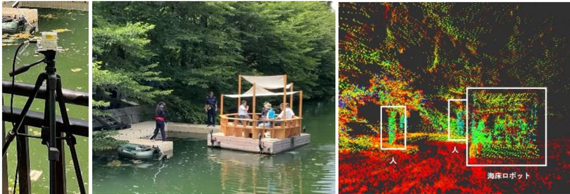
(左) 陸側に設置した LiDAR センサ (中央) カメラデータ (参考) (右) LiDAR データ
