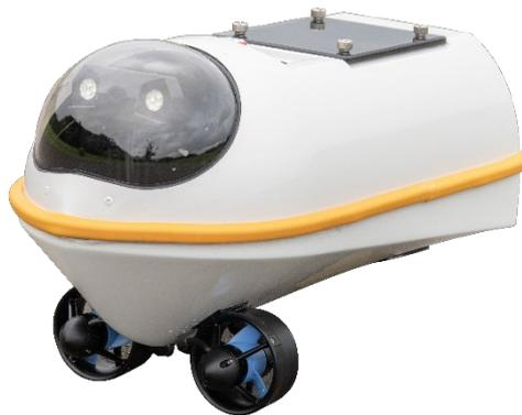
全長0.6m、軽量約7kg、組立不要。持ち運び～使用～片づけまで一人ででき、省人化を後押しします。スイッチを入れて1分で起動、陸地から遠隔操作で水域の『見る』『撮る』『測る』仕事を行い、水域で働く方々の業務効率性と安全性の向上に貢献します。
