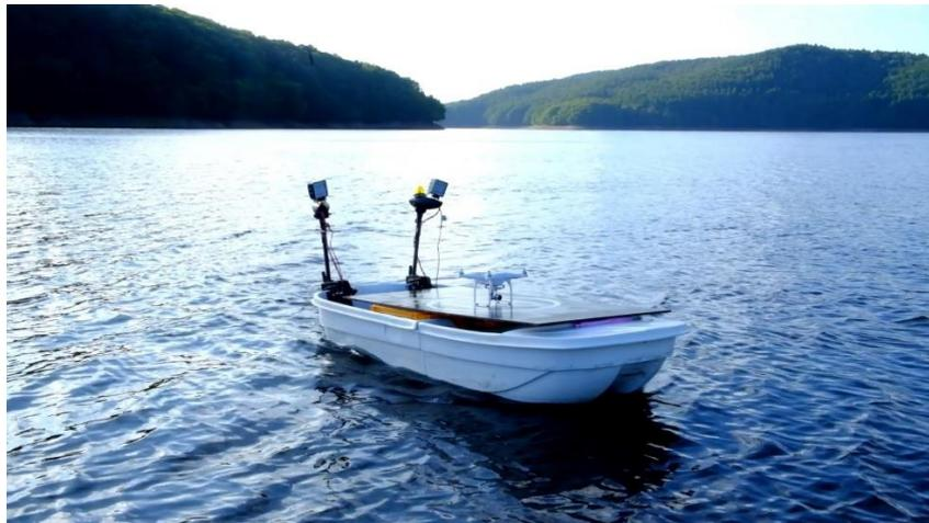
Marine Drone は、水上モビリティを提供する水上ドローンです。作業の目的に応じた様々な機器と連携することで、水上作業の自動化や効率化、安全性の向上に貢献します。昨今の情報セキュリティや安全性の観点から、総務省 2015 年度 異能 vation の支援を得て開発された高信頼性組込 OS が用いられており、自律移動等の制御系も含めてオープンソースを使用せずに開発した純国産の水上ドローンです。インフラ点検や災害対策などへの応用を意識し、今後も純国産の開発・改良を行います。
